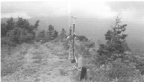
写真2 設置した気象観測機器
